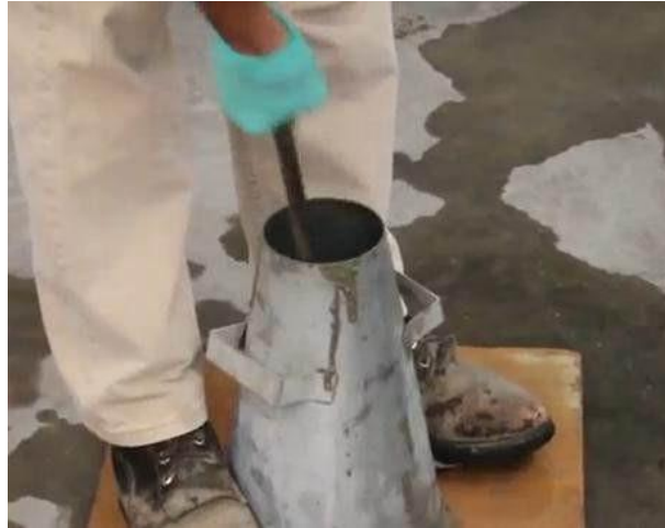
Figura 404 - 3. Apisonado de una capa con la varilla
