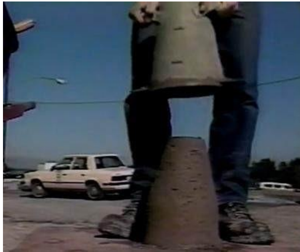
Figura 404 - 5. Remoción del molde
