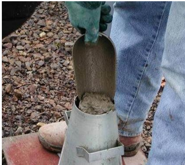
Figura 404 - 2. Colocación del concreto en el molde con el cucharón
