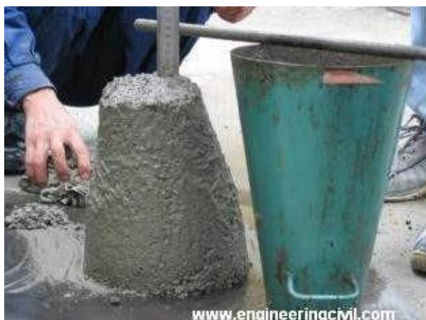
Figura 404 - 6. Medida del asentamiento (Fuente: www.engineeringcivil.com )
